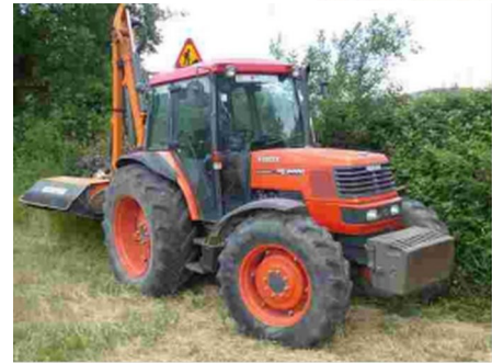
Passage de l'épareuse sur l'ensemble de la voirie communale.
